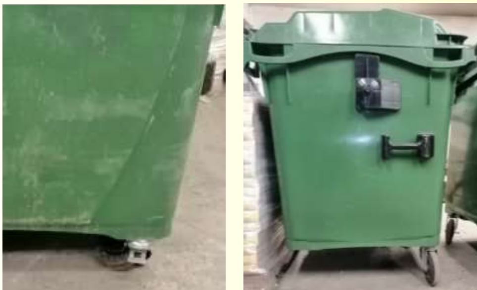
Slika 13: Poškodba kolesa na zabojniku za steklo
